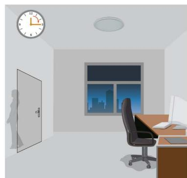
Dopo un tempo di attesa predefinito, la luce si spegne automaticamente se non viene rilevato alcun movimento. After the hold time then switch off automatically when no movement is detected.
