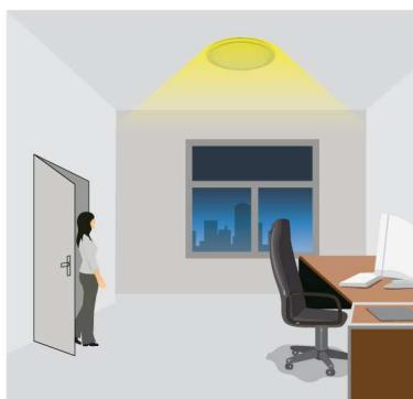
Con la luce naturale insufficiente, il sensore accende la luce automaticamente quando qualcuno entra nella stanza.
